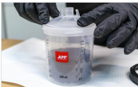
Поместите крышку со встроенным ситечком на мягкий бачок и надавите на нее до упора. Соединение с мягким бачком должно быть герметичным.
