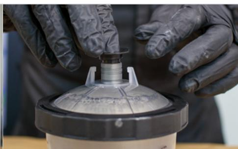
Отсоедините бачок от пистолета, выполняя действия, противоположные его установке. Плотнo закройте носик мягкого бачка пробкой. Открутите крышку от жесткого бачка и выньте из нее мягкий бачок с крышкой. В случае проблемы с извлечением осторожно вытолкните его вверх через отверстие в нижней части внешнего жесткого бачка.
