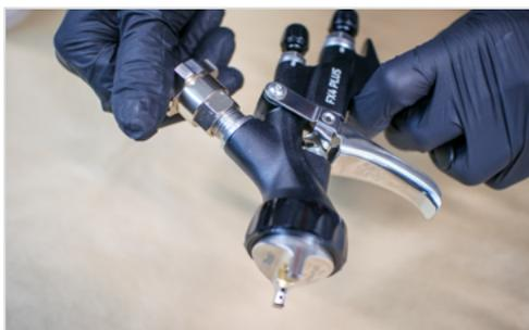
Прикрепите соответствующий разъем FPS в краскопульте к разъему осадочного бачка. Соединение должно быть герметичным и механически устойчивым.
