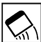
Наносите шпателем тонким слоем в течение времени нанесения, т.е. в течение примерно 3-6 минут.
