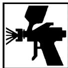
Наносить с помощью пистолета-распылителя, оснащенного форсункой  $\varnothing 1,5\text{-}\varnothing 1,8$  мм при давлении воздуха от 2,0 до 3,0 бар.
