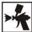
Наносить с помощью пистолета-распылителя оборудованного соплом Ø1,3-Ø1,5 мм при давлении воздуха от 3,0 до 4,0 бар.
