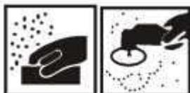
Тщательно устранить возможные очаги коррозии и шлифовать сухим методом наждачной бумагой P240-P320.
