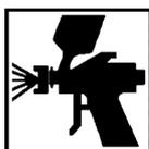
Наносить краскопультom с соплом  $\varnothing 1,3$ - $\varnothing 1,5$  мм при давлении воздуха от 2,0 до 3,0 бар.
