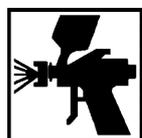
Наносить краскопультom с соплом  $\varnothing 1,3$ - $\varnothing 1,4$  мм при давлении воздуха от 2,0 до 3,0 бар.
