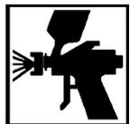
Mit einer Spritzpistole mit Düse  $\varnothing 1,6\text{-}\varnothing 1,8$  mm bei einem Luftdruck von 2,0 bis 3,0 bar auftragen.
