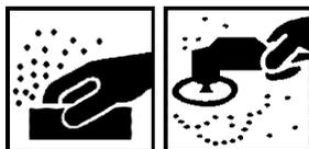
Die behandelte Oberfläche sollte frei von Rost, Zunder, Öl, Fett, lose anhaftender Altbeschichtung, Staub und anderen Verunreinigungen sein. Sie sollte einen einheitlichen metallischen Glanz haben.
