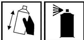
Хорошо перемешайте содержимое упаковки, встряхивая ее в течение 2-3 минут. Выполнить пробное распыление. Равномерно покрыть окрашиваемую поверхность с расстояния 20-30 см.
