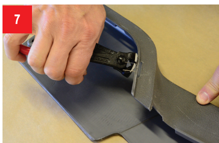
7 Выступающие концы скоб обрезаем с помощью кусачек.
