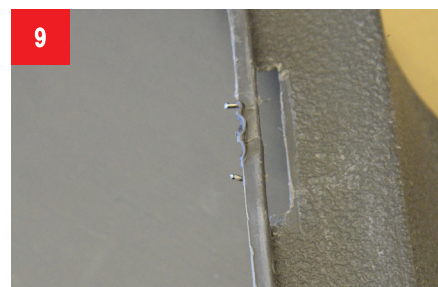
9 Выступающие после обрезки концы скоб необходимо зашлифовать (например, с помощью шлифовальной машины APP № 139102).
