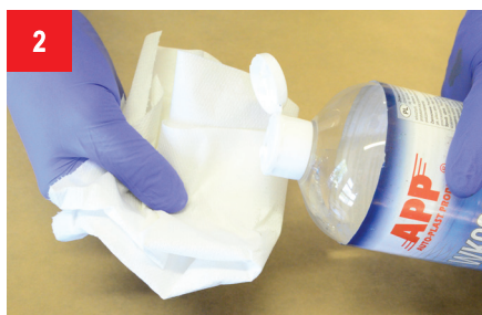
2 Прежде чем приступить к ремонту, необходимо очистить и обезжирить поверхность с помощью WK900.
